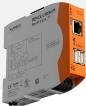
RevPi Coreは幅22.5mmとRevPi Connectの半分しかないが、PiBridgeコネクタは2個で2倍の数。そのため、RevPi Coreは最大10個の拡張モジュールを搭載してアップグレード可能。
