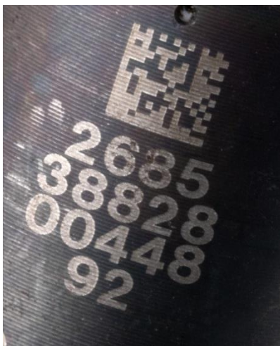
ダイレクトパーツマーキング:金属上にレーザーを使用しマーキング
